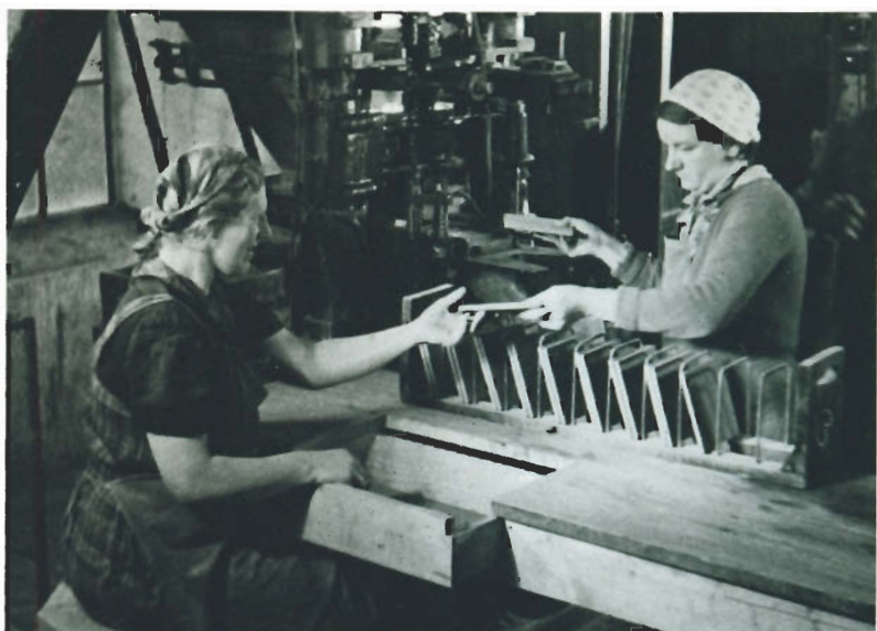
Fig. 4. Når fliserne var pressede i form, stilledes de til tørre for senere at blive påmalede deres endelige dekoration. Billedet må formodes at være fra slutningen af 1930'erne.
